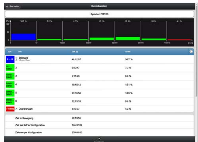
Betriebsdauer in verschiedenen Drehzahlbereichen Visualisierung des konfigurierbaren Betriebsstundenzählers im MiniCODER plus
