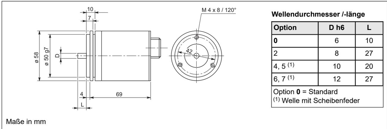
Maßbild GEL 208 – Drehgeber mit Klemmflansch, Steckerabgang axial
