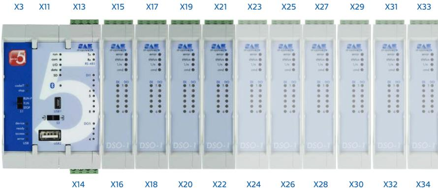
Um die Stabilität des Grundsystems nicht zu gefährden, wurde die Stromversorgung der Module durch die Basisstation auf 1,2 A begrenzt. Daher können bis zu 4 Erweiterungsmodule des Typs DSO-1 eingesetzt werden (hell dargestellt Module dienen nur der Klemmenzuordnung). Ab setIT V5.001 und mit einer Zusatzversorgung PWR-1 an letzter Position können max. 12 EWB eingesetzt werden. Die Anzahl und Art der Erweiterungsbaugruppen muss mit dem konfigurierten Projekt in setIT übereinstimmen.
