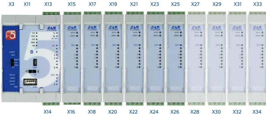
Um die Stabilität des Grundsystems nicht zu gefährden, wurde die Stromversorgung der Module durch die Basisstation auf 1,2 A begrenzt. Daher können bis zu 6 Erweiterungsmodule des Typs 8DO eingesetzt werden (hell dargestellte Module dienen nur der Klemmenzuordnung). Ab setIT V5.001 und mit einer Zusatzversorgung PWR-1 an letzter Position können max. 12 EWB eingesetzt werden. Die Anzahl und Art der Erweiterungsbaugruppen muss mit dem konfigurierten Projekt in setIT übereinstimmen.
