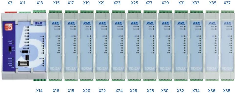
Um die Stabilität des Grundsystems nicht zu gefährden, wurde die Stromversorgung der Module durch die Basisstation auf 1,0 A (+200 mA Toleranz) begrenzt. Daher können bis zu 10 Erweiterungsmodule des Typs 8DI2A eingesetzt werden. Ab setIT V5.001 und mit einer Zusatzversorgung PWR-1 an letzter Position können max. 12 EWB eingesetzt werden. Die Anzahl und Art der Erweiterungsbaugruppen muss mit dem konfigurierten Projekt in setIT übereinstimmen.
