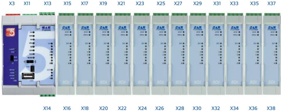
Um die Stabilität des Grundsystems nicht zu gefährden, wurde die Stromversorgung der Module durch die Basisstation auf 1,0 A (+200 mA Toleranz) begrenzt. Daher können bis zu 12 Erweiterungsmodul des Typs 8DI eingesetzt werden. Die Anzahl und Art der Erweiterungsbaugruppen muss mit dem konfigurierten Projekt in setIT übereinstimmen.
