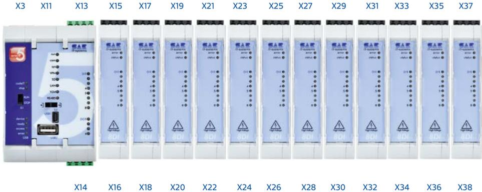
Um die Stabilität des Grundsystems nicht zu gefährden, wurde die Stromversorgung der Module durch die Basisstation auf 1,0 A (+200 mA Toleranz) begrenzt. Daher können bis zu 12 Erweiterungsmodule des Typs 8DI-220 eingesetzt werden. Die Anzahl und Art der Erweiterungsbaugruppen muss mit dem konfigurierten Projekt in setIT übereinstimmen.
