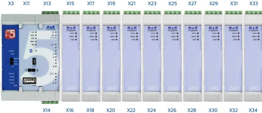
Um die Stabilität des Grundsystems nicht zu gefährden, wurde die Stromversorgung der Module durch die Basisstation auf 1,2 A begrenzt. Daher können bis zu 12 Erweiterungsmodule des Typs 2A0 eingesetzt werden. Die Anzahl und Art der Erweiterungsbaugruppen muss mit dem konfigurierten Projekt in setIT übereinstimmen.
