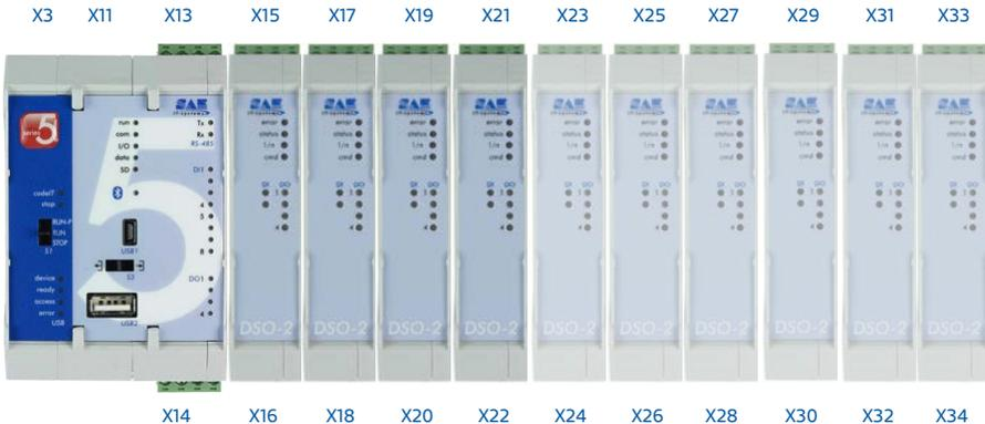
Um die Stabilität des Grundsystems nicht zu gefährden, wurde die Stromversorgung der Module durch die Basisstation auf 1,2 A begrenzt. Daher können bis zu 4 Erweiterungsmodule des Typs DSO-2 eingesetzt werden (hell dargestellte Module dienen nur der Klemmenzuordnung). Ab setIT V5.001 und mit einer Zusatzversorgung PWR-1 an letzter Position können max. 12 EWB eingesetzt werden. Die Anzahl und Art der Erweiterungsbaugruppen muss mit dem konfigurierten Projekt in setIT übereinstimmen.
