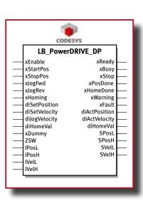
Funktionsbausteine zur Einbindung des Stellantriebs in die Anlagensteuerung sparen Zeit und Geld beim Software-Engineering
