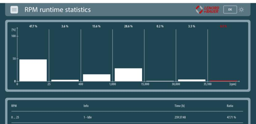
Nos MiniCODER offrent la possibilité d'une acquisition intégrée des données de l'état de fonctionnement. Pendant le temps de fonctionnement, les conditions d'utilisation telles que les températures minimale et maximale ainsi que les plages de vitesse de rotation sont détectées. En cas de recours au service après-vente ou à la garantie, on peut ainsi vérifier si un moteur a été utilisé au-delà de la vitesse de rotation admissible.
