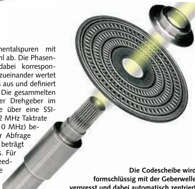
Die Codescheibe wird formschlüssig mit der Geberwelle verpresst und dabei automatisch zentriert
