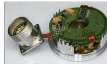
Innovative Aufbau- und Verbindungstechnik: keine internen Schraub-/Steckverbindungen, kompaktes mechanisches Getriebe.
