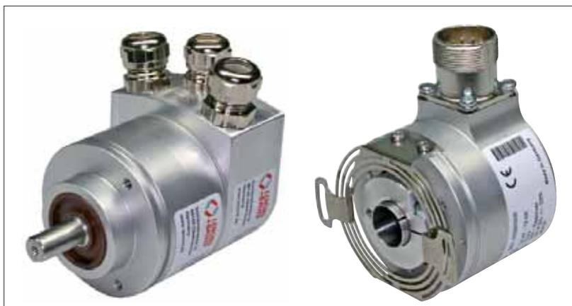
Bild 1. Ein kompaktes Industriegehäuse mit 58 mm Durchmesser bei 47 mm Gehäuselänge für Singleturn und Multiturn mit mechanischem Getriebe. Die Aufsteckhohlwelle hat einen Innendurchmesser von 15 mm.
