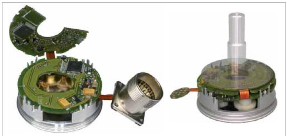
**Bild 7.** Nach der Montage der Starr-Flex-Starr-Platinen auf den Gehäuseboden wird das mechanische Getriebe vollständig geprüft und abgeglichen, dann folgt der Test der Singleturn-Elektronik. Die spätere Position der Stegscheibe ist schematisch gezeigt.
