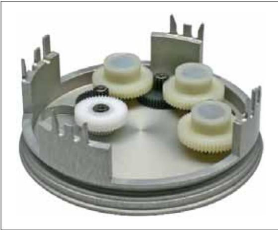
**Bild 6.** Bei der Multiturn-Variante folgen dem Eingangszahnrad mit separater Kugellagerung drei Hauptachsen mit jeweils 16-facher Untersetzung, damit wird eine Auflösung von  $16^3 = 2^{12}$  Umdrehungen erreicht.
