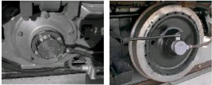
Der Multikanal-Impulsgeber wurde speziell für die Anforderungen der Schienenfahrzeugindustrie entwickelt. Der Drehgeber wurde so konstruiert, dass er unabhängige Ausgangssignale für unterschiedliche Steuerelektroniken, wie Motordrehzahlerfassung, Gleitschutz, Zugsicherung und Rollwegerfassung liefert.
